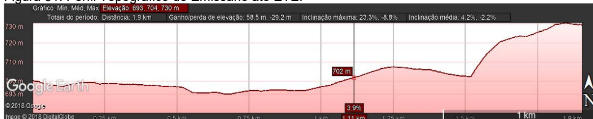
Figura 31: Perfil Topográfico de Emissário até ETE.
